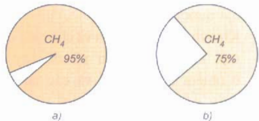
Hình 4.18. Hàm lượng metan trong khí thiên nhiên (a) và trong khí mỏ dầu (b)
