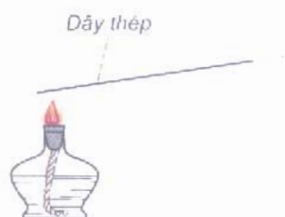
Hình 2.2 Thí nghiệm về tính dẫn nhiệt của kim loại
